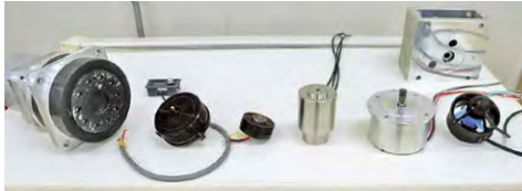
製造しているコイルを使用した自社モーターの一部
